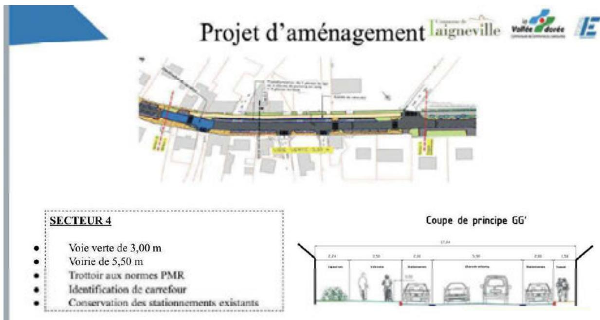
Les travaux commenceront par la réfection des réseaux d'assainissement et la mise en conformité des branchements en eau potable. Les enfouissements des réseaux divers auront lieu avant les travaux d'aménagement urbain et la finition des trottoirs.
